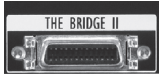
Figura 1. Conector The Bridge II en el producto Harman Kardon compatible con The Bridge II
